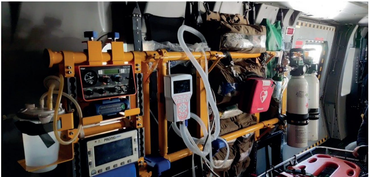
Sistema de estibación de equipos médicos en el NH90
