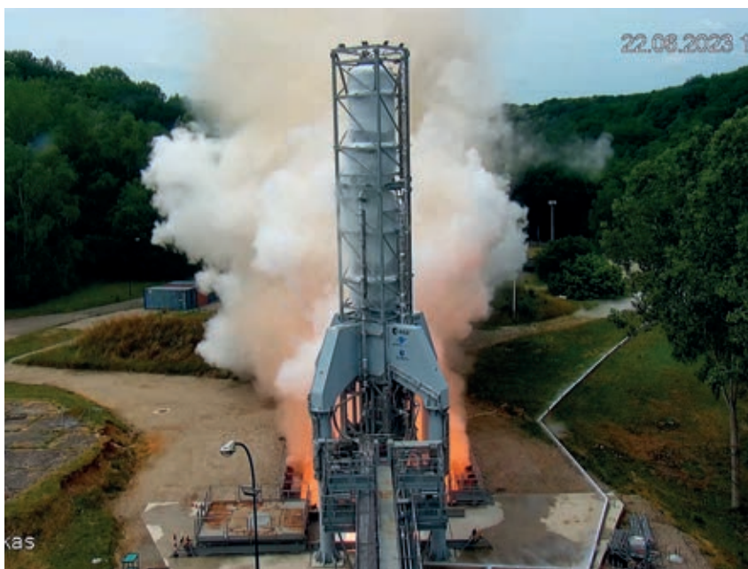
Ignición del motor Prometheus en Vernon, el 22 de junio de 2023. (Imagen: ArianeGroup)
