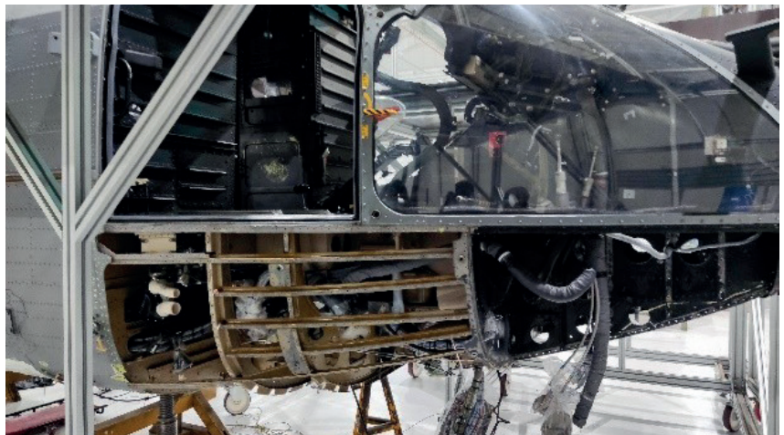
Proceso de reparación del Super Puma en MAESMA
