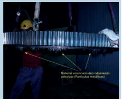
Corona principal con material adherido procedente del rodamiento principal
