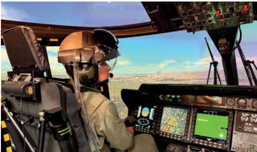
El simulador del NH90 permite el entrenamiento con el equipamiento de visión nocturna. (Imagen: Indra)
