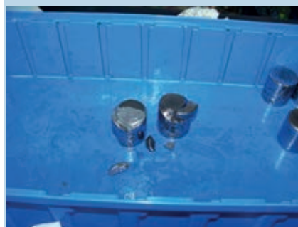
Rodillos del rodamiento principal. Nótese su nivel de destrucción
