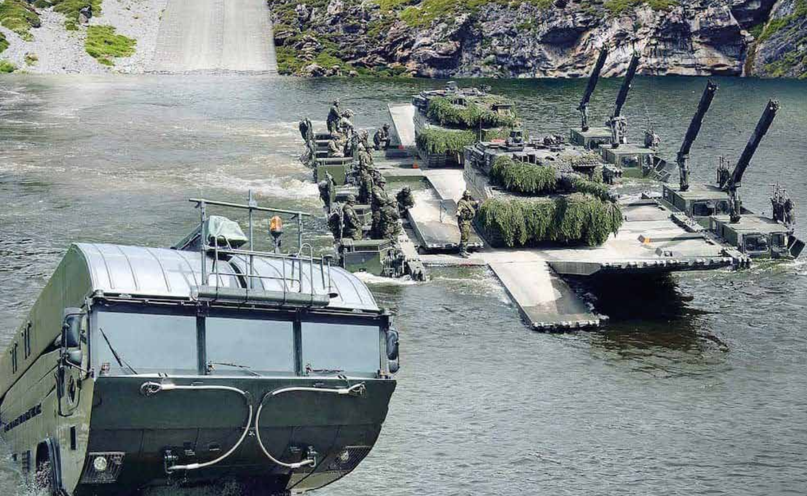
Vehículo anfibio M3. Plegado y como compuerta de 4 vehículos. Fuente: General Dynamics European Land Systems (GDELS)
